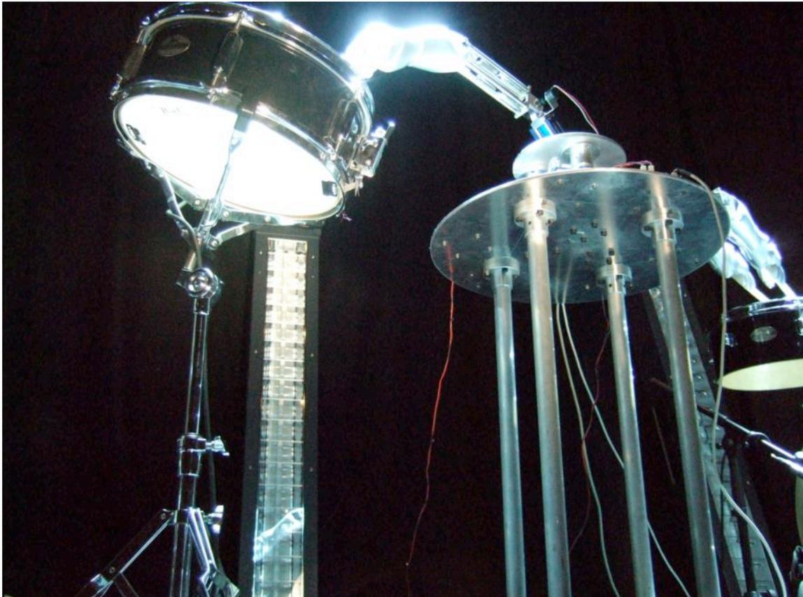
L'avantage principal de "RoboticMusic" est de jouer interactivement d'instruments acoustiques avec l'aide d'un ordinateur. Cela permet de jouer des rythmes complexes et de dépasser facilement les capacités humaine d'exécution. Par conséquent, cela ouvre de nouvelles possibilités dans le domaine de la composition pour les instruments acoustiques.
